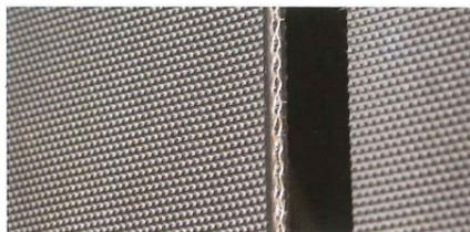
高い耐久性と柔軟性を備え、接続部を持たないエンドレスベルトを採用しました。ベルトの芯材には高強度合成繊維を使用しており、伸びが少なく長い年数に渡り高水準のパフォーマンスを発揮します。
