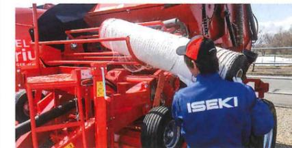
ネットの装填や、予備ネットの搭載はペーラーに登ることなく行えます。幅が1230~1300mmのネットを使用することが可能で、ネット固定はハンドル操作で簡単に行えます。
