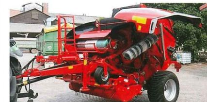
サイドカバーは上方向に開閉します。内部に配置された予備ネットの取り出しが容易になったのはもちろんのこと、メンテナンス時の機械部品へのアクセス性も向上しました。
