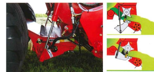
作業効率を左右するピックアップ部には、ウェルガー独自のシステムが搭載されています。草の量が多いときにはダンパーが働き、ボトムプレートが下がるので多くの牧草がチャンバーへ流れるようになります(フレックスシステム)。牧草が詰まったときには、油圧操作によりボトムプレートを完全に下げることが可能です。キャビンから降りることなく詰まりを取り除き、安全に作業を続けることが出来ます。
