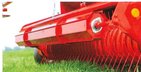
作物のピックアップ効率を最大限に高めるため、カムレス・ピックアップを採用。長く、しなやかに設計されたティンは、あらゆる条件下で、最もきれいに作物を集められる角度に調整されています。ピックアップユニット自体が従来よりコンパクトになり、ペーラー内のメインローターにより近く配置されています。これによりスムーズな作物の流れを生み出します。
