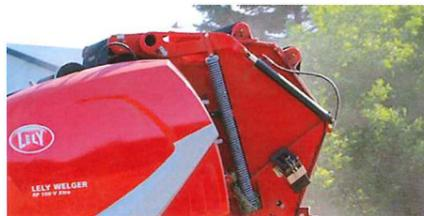
ベルトテンションは独立回路の油圧シリンダーにより制御されます。油圧バルブの絞りを変更することによりベルトテンションにかかる圧力を変化させ、ペール密度を調整しています。この操作はコントローラーから行なうことが出来ます。
