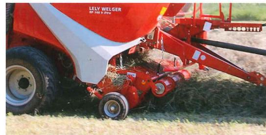
クロープ・プレスローラーは、スワースの大小にかかわらず、作物を作業幅全域に渡り均一に広げる役割を持っています。作物の量が少ない場合は、ローラーの回転により作物を左右に広げます。作物の量が多い場合は、スワース全体にローラーを押し付けることで、塊を作ることなく作物をスムーズにチャンバー内部へ導きます。スムーズな作物の流れは美しいペール形状につながります。
